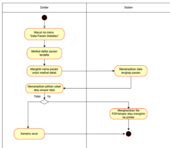
Gambar 11 Activity Diagram Data Pasien Alur dimulai ketika Dokter mengakses menu "Data Pasien Diabetes" dan memilih nama pasien tertentu agar sistem dapat menampilkan rincian data lengkap secara otomatis. Selanjutnya, Dokter diberikan opsi untuk mencetak atau mengekspor data tersebut, di mana sistem akan menghasilkan file PDF atau mengirim perintah ke printer jika setuju, atau kembali ke menu awal jika tidak.
