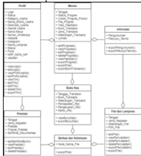
Gambar 5 Class Diagram Sistem Informasi Start Up Vokasi
