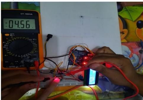
Gambar 21. Pengujian Sensor MAX30100
